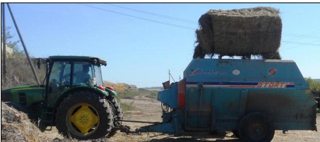
Рис. 2. Загрузка грубых кормов в бункер миксера
