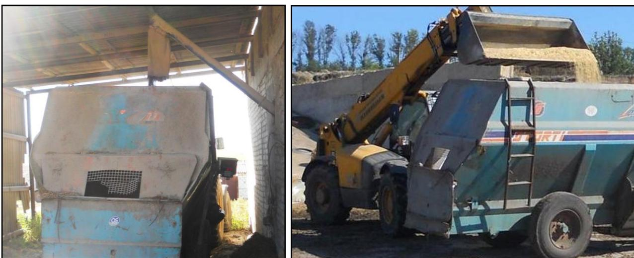
Рис. 3. Загрузка концентратов в бункер миксера
