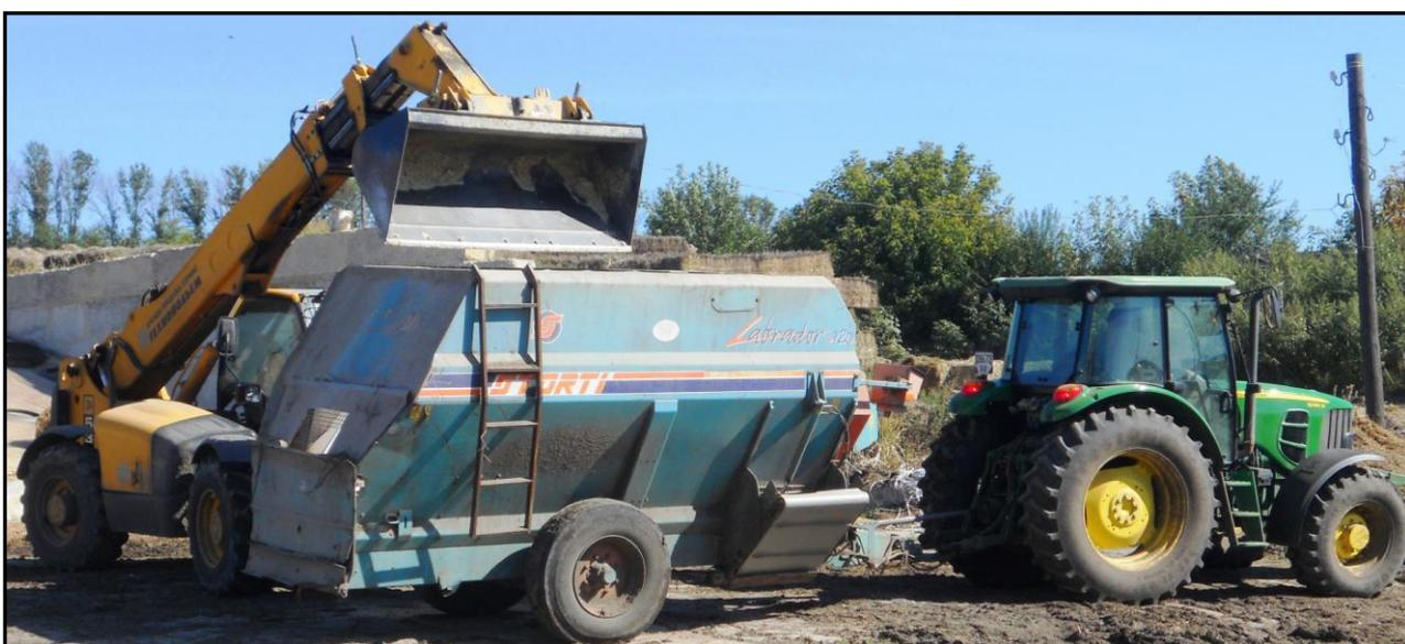
Рис. 4. Загрузка силосованных кормов в бункер миксера
