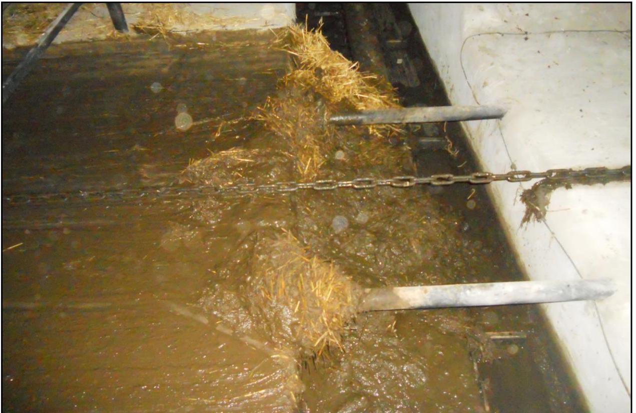
Рис. 3. Работа дельта-скреперной установки в помещении
